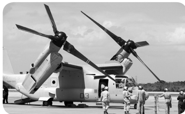
最大速度520km/h 行動半径600km/h 搭載量5.7t
